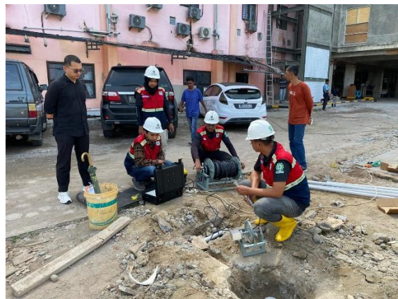
Kegiatan Pengawasan Uji Pemompaan dan Borehole Camera dalam rangka penerbitan izin pengusahaan air tanah.
