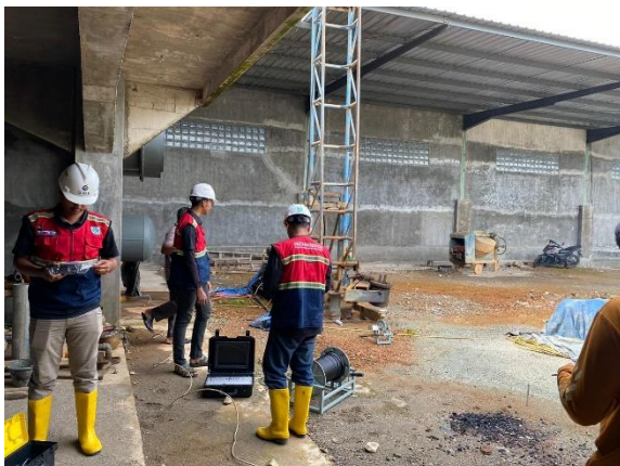
Kegiatan Pengawasan Uji Pemompaan dan Borehole Camera dalam rangka penerbitan izin pengusahaan air tanah.
